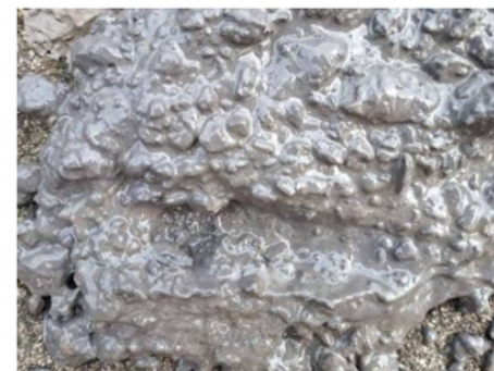
Charakteristický odvrtek z prostředí prachovitých břidelic 11,5-15 m.
