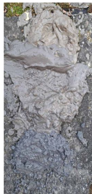
Charakteristický odvrtek z prostředí prachovitých břidelic 11,5-15 m.
