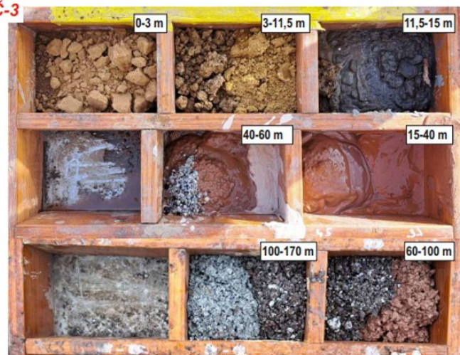
Vzorkování vrtné drtě z vrtu TČ-3.
