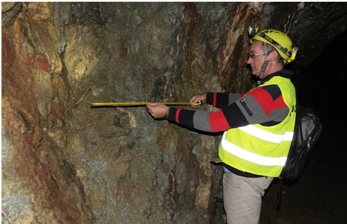
Obr. 5. Vyměřování instalace 3D dilatometru TM-71 na lokalitě Josef (JOS1).
