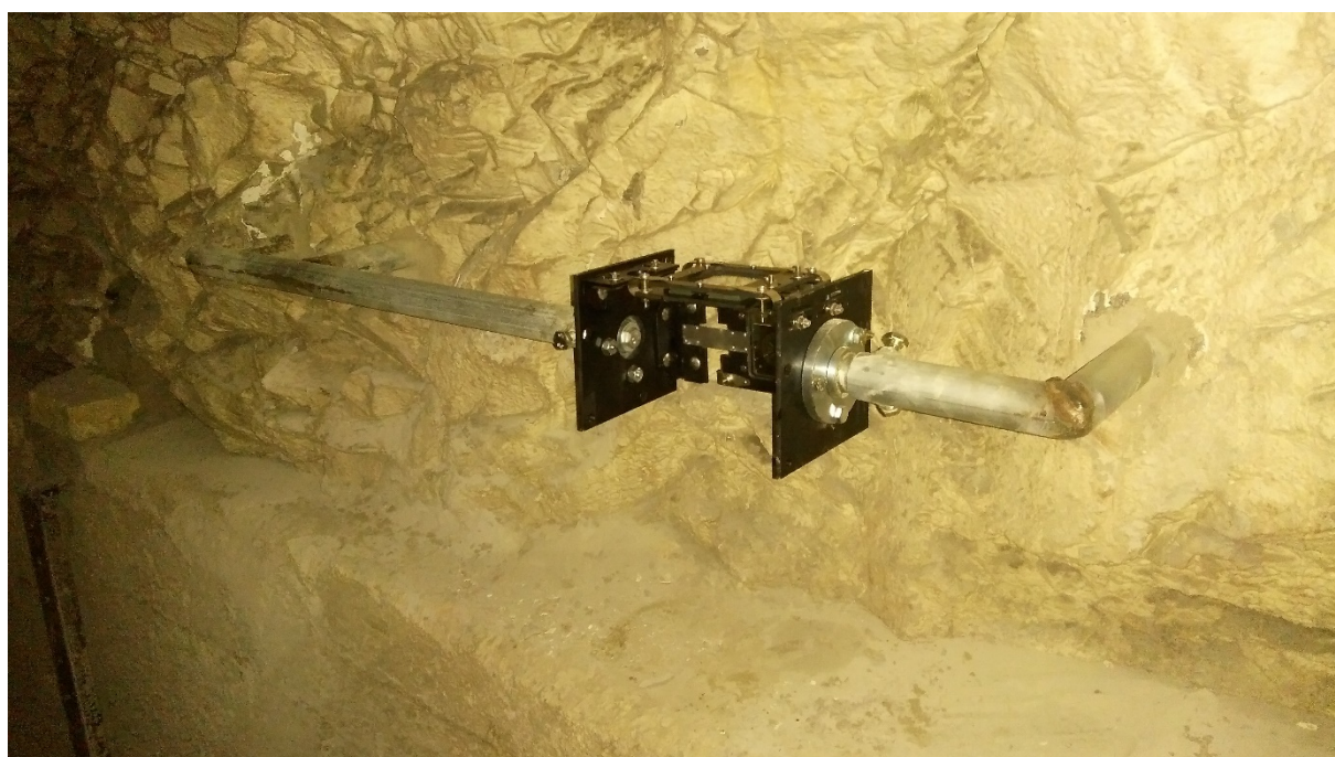
Obr. 12. Nainstalovaný přístroj TM-71 (přístroj RIC2 – bývalá podzemní továrna Richard)
