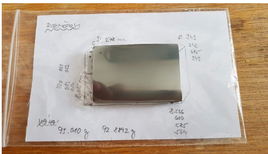
Obr. 6: Připravený zkušební vzorek leštěné oceli N80 pro korozivní interakční testy.
