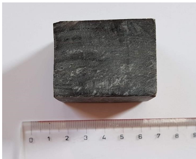
Obr. 1: Modelový horninový vzorek před zahájením loužicích experimentů.
