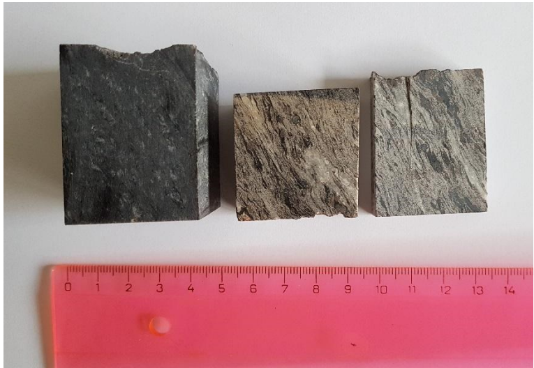
Obr. 5: Porovnání vlivu loužení na horninu. Zleva: referenční neloužený vzorek horniny, uprostřed vzorek po 1 měsíci loužení, vpravo vzorek po 3 měsících loužení.
