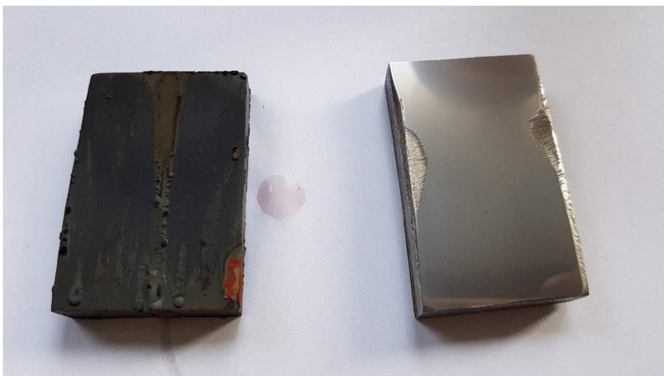
Obr. 8: Detail korodovaného vzorku oceli a referenčního vzorku bez koroze. Výška vzorku je 4,5 cm.
