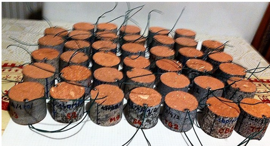
Obr. 4 Ilustrační foto - vzorky hornin připravené na měření rezistivity s plazmaticky (Cu) upravenými čely jader.
