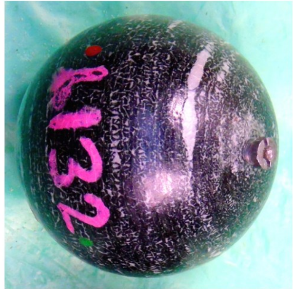
Obr. 6 Příprava kulového vzorku a jeho orientace. Vlevo – válcový polotovár po prvním vrtání. Vpravo – připravený kulový vzorek L132. Červená tečka: osa válcového vzorku vlevo, paralelní s foliací. Zelená (bílá) tečka: horizontální směr, kolmý k ose válcového vzorku vlevo, paralelní s foliací. Převzato z Petružálka (2018).
