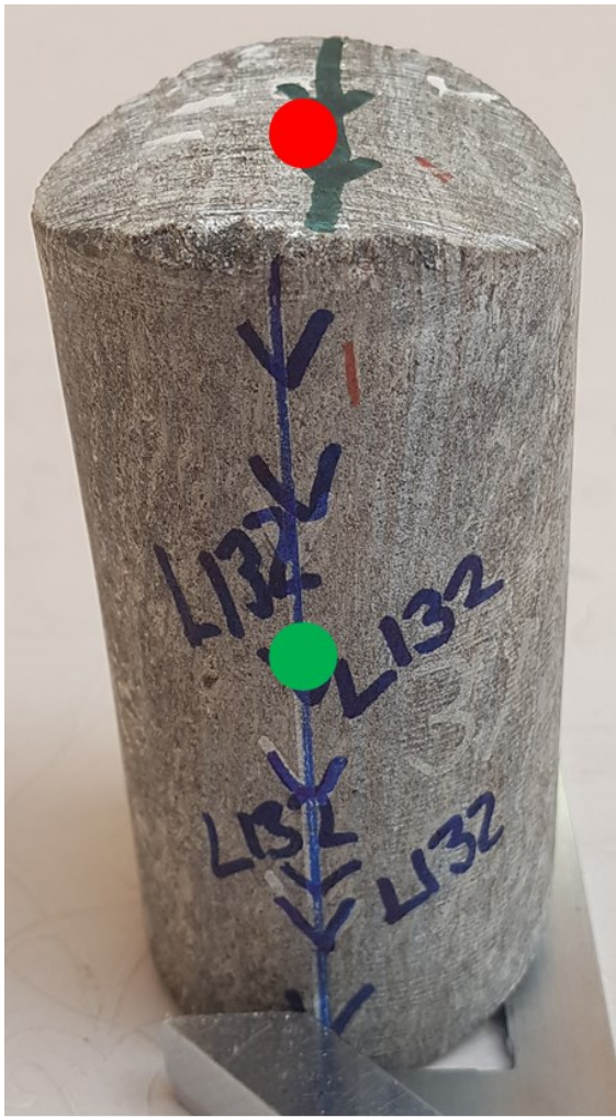
Obr. 6 Příprava kulového vzorku a jeho orientace. Vlevo – válcový polotovár po prvním vrtání. Vpravo – připravený kulový vzorek L132. Červená tečka: osa válcového vzorku vlevo, paralelní s foliací. Zelená (bílá) tečka: horizontální směr, kolmý k ose válcového vzorku vlevo, paralelní s foliací. Převzato z Petružálka (2018).
