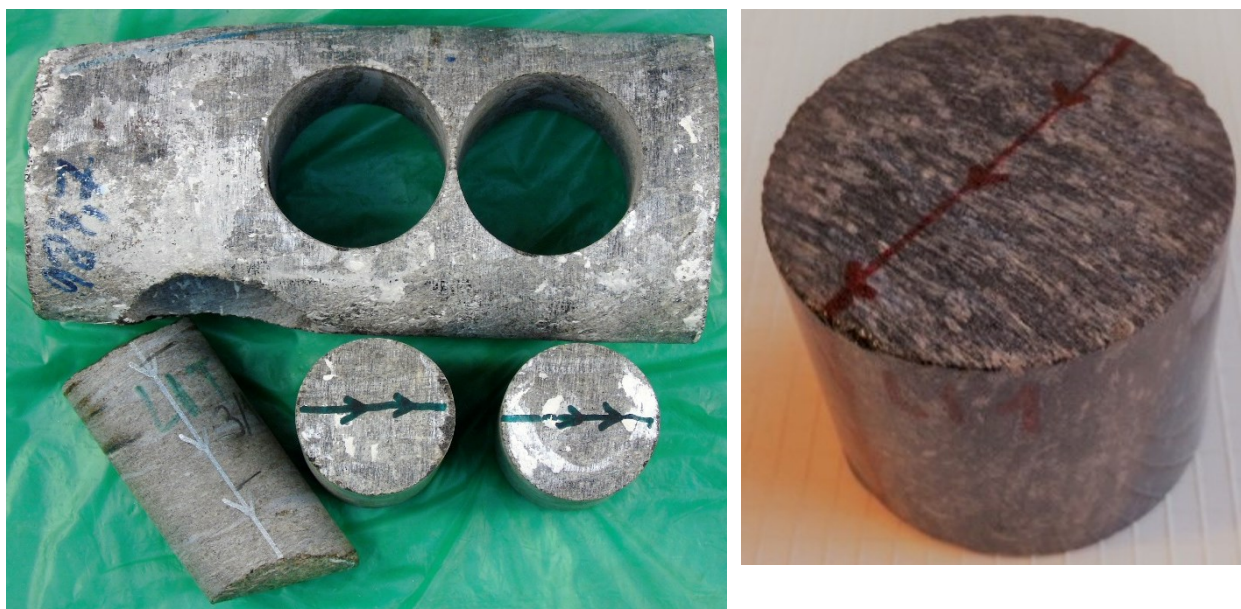
Obr. 1 Fotodokumentace vrtného jádra z vrtu PVGT-LT1 z hloubky 984,7 m v průběhu jeho zpracování – orientované převrtání a nařezání na vzorky tvarem a velikostí vhodné pro jednotlivé plánované analytické práce. Orientovaný vzorek na pravém obrázku určený pro petrofyzikální charakteristiky má průměr 48 mm a výšku 40 mm.
